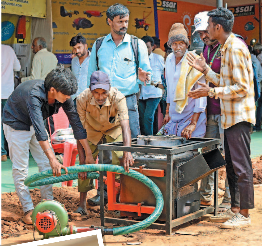
ಬೆಂಗಳೂರಿನ ಜಿಕೆವಿಕೆಯಲ್ಲಿ ನಡೆದ ಕೃಷಿಮೇಳದಲ್ಲಿ ಪ್ರದರ್ಶನಗೊಂಡ ಕಡಿಮೆ ಕಟ್ಟಿಗೆ ಬಳಸಿ ಹೆಚ್ಚು ಜನರಿಗೆ ಅಡುಗೆ ಮಾಡಬಹುದಾದ ಒಲೆ ಚಿತ್ರ: ರಂಜು ಪಿ
